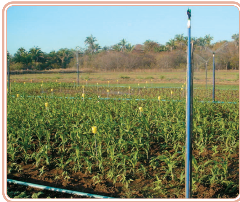
Figura 3.3: Coletores entre os aspersores
