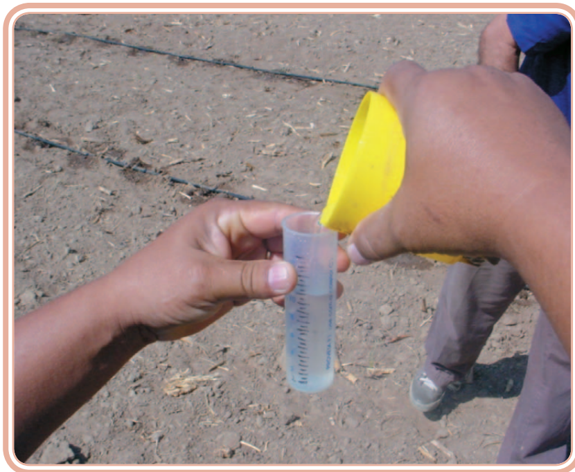
Figura 3.6: Medida do volume de água coletado
