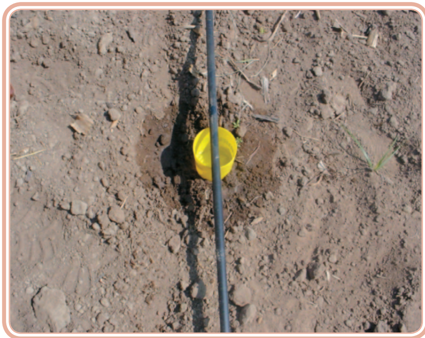
Figura 3.5: Coleta do volume de água
