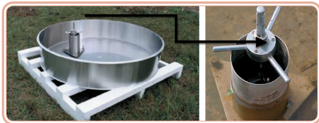
Figura 6.5: Tanque Classe A com parafuso micrométrico no detalhe
