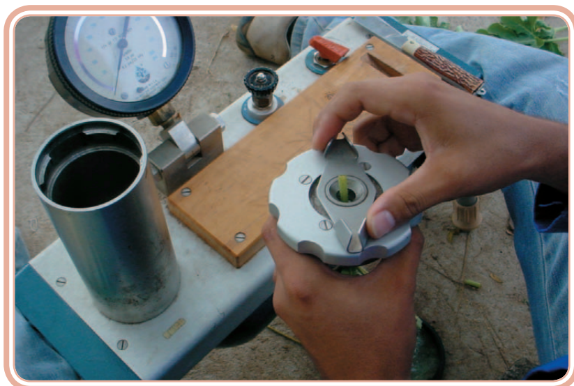
Figura 6.9: Colocação da folha no cilindro
